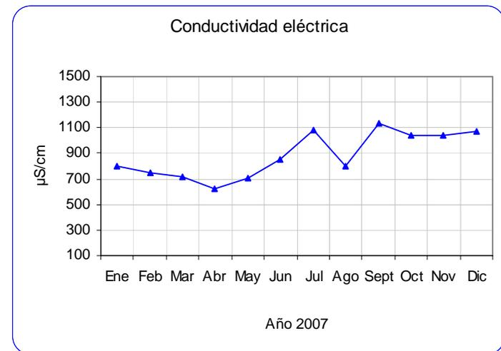
Fig. 2.37 Variación temporal de la conductividad eléctrica
